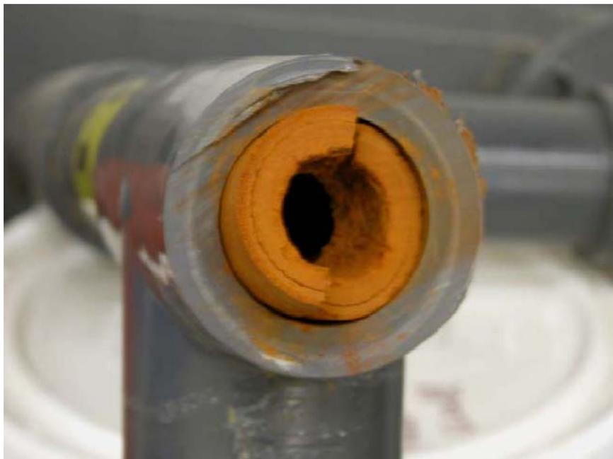
Photo 1 : Une couche épaisse de bactéries se forme dans une conduite d'eau
